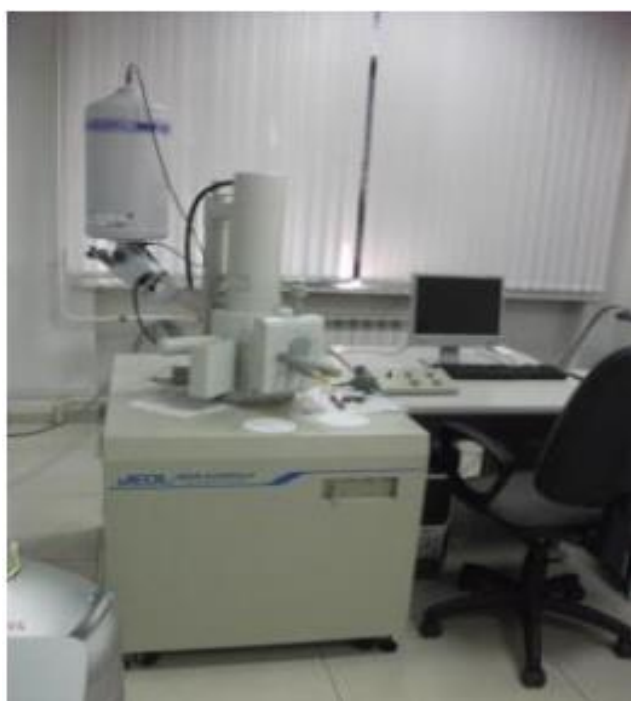
Сурет 14 – Растрлық электрондық микроскоптың сыртқы түрі және блок схемасы
